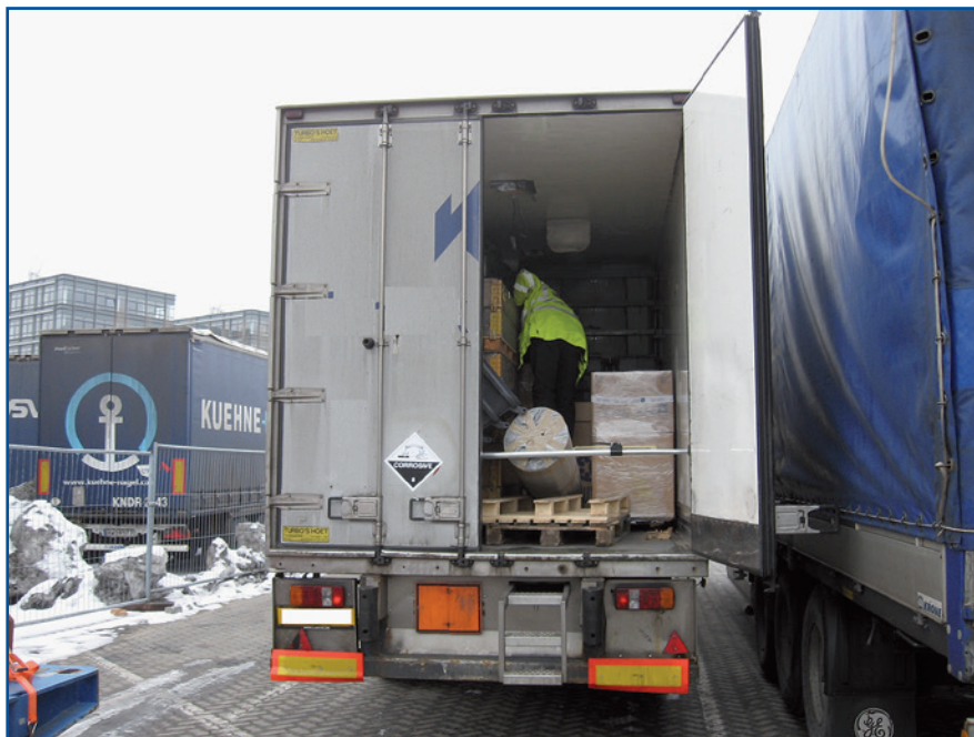
Kontrolle einer Cargo Transport Unit (CTU) mit Gefahrgut hinsichtlich der richtigen Deklaration und Verpackung sowie auf Einhaltung der Ladungsvorschriften.
