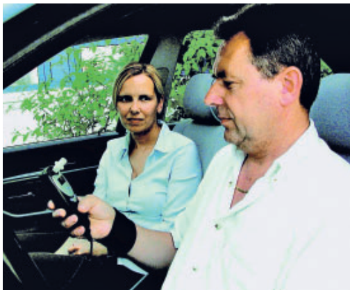
Moderner Atemalkoholtest mit elektronischem Interlock. Fotos (7): Dräger Safety AG & Co. KGaA
